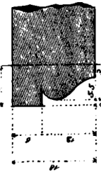
f_{21} — Archivolte des voûtes d'évidement Coupe sur ss de f_{18} — 10^m
